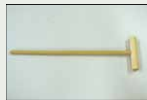
⑦アンカー材料押し出し棒
