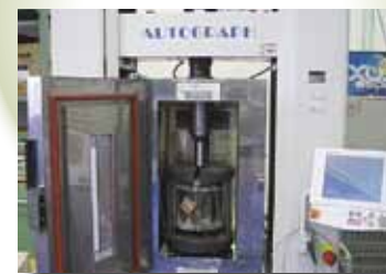
加熱状態での引張試験状況
